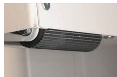
Nuovo sistema di grecatura del dorso Fastbind PGO (Paper Grain Opening) Microcut
